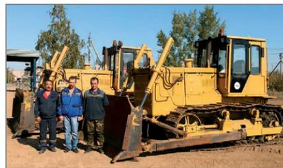
произведен капитальный ремонт двух бульдозеров. Машины были полностью перебраны, покрашены (кроме ковшей из целесообразности), и они стали такими по эксплуатационно-технологическим характеристикам, словно только что вышли с конвейера».
